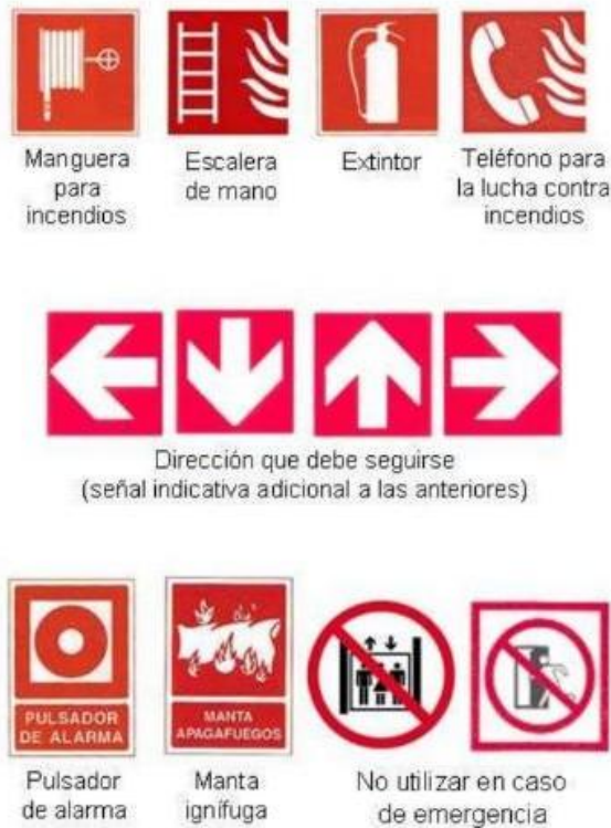
Ilustración 5. Señales relativas a equipo de lucha contra incendios
